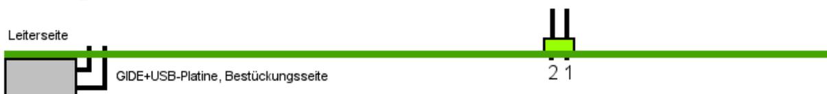
Denkbar ist auch ein Vertauschen von Buchsen- und gerader Stiftleiste, also Buchsenleiste auf der GIDE+USB-Platine und Stiftleiste auf dem Adapter. Für die Buchsenleiste ist es zweckmäßig, eine flache (5mm) Ausführung zu benutzen.
